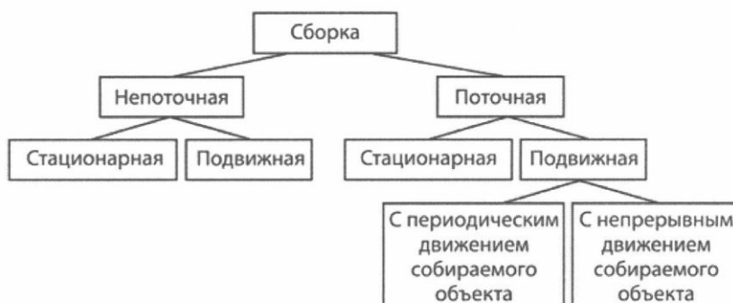
Рисунок 3. Виды и организационные формы производственных процессов сборки изделия
